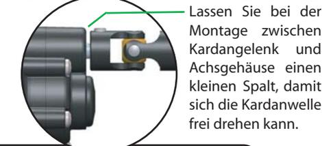
Lassen Sie bei der Montage zwischen Kardangelen und Achsgehäuse einen kleinen Spalt, damit sich die Kardanwelle frei drehen kann.
